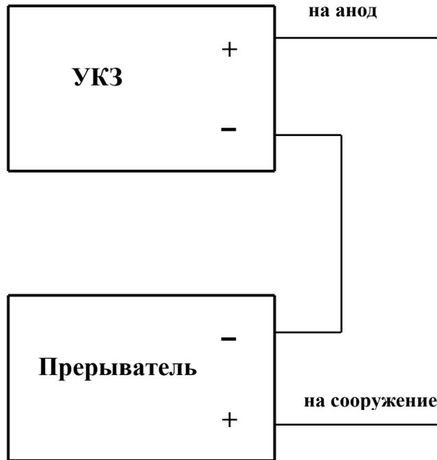
Рисунок 6.1 — Подключение прерывателя к УКЗ
